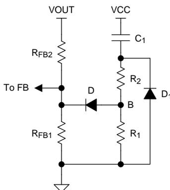
**Figure 12. Soft-Start Circuit**
