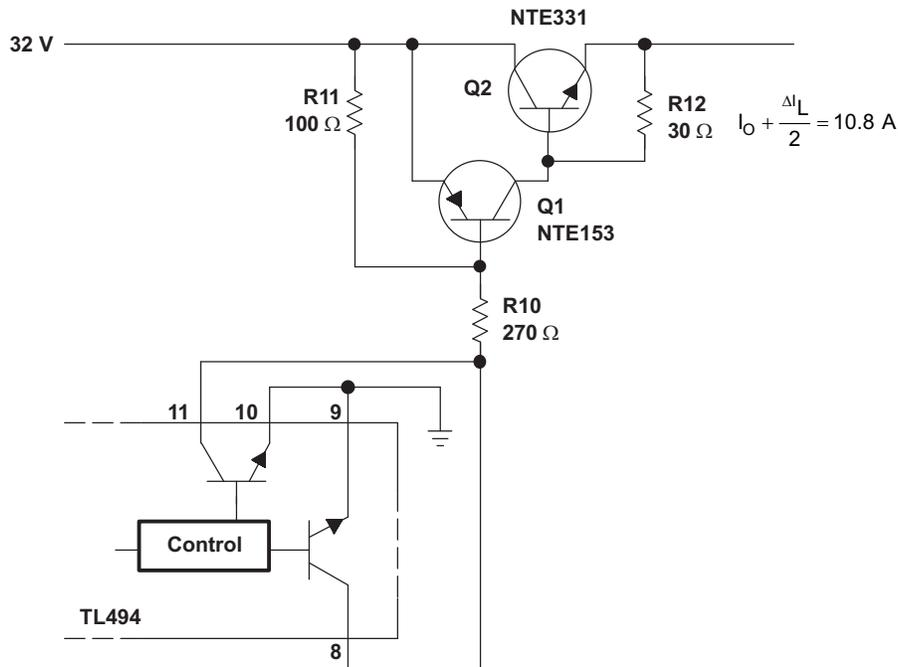
**Figure 15. Power-Switch Section**
